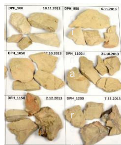
Vliv teploty výpalu na vlastnosti NHL z dvorecko-prokopských vápenců
